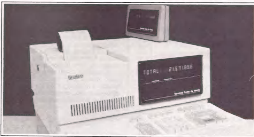
Controlado por I-7000 PC/XT, o I-5000 armazena até 100 mil itens em sua memória
